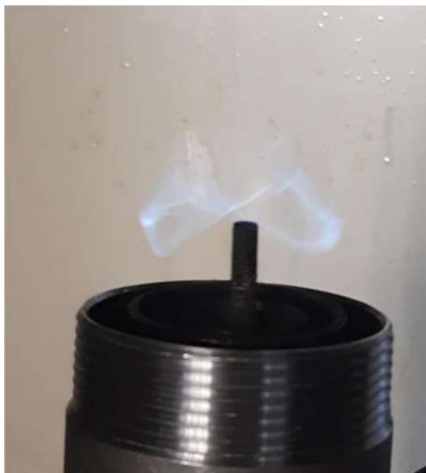
Рисунок 11 - Коронное пламя при сжигании гексана
